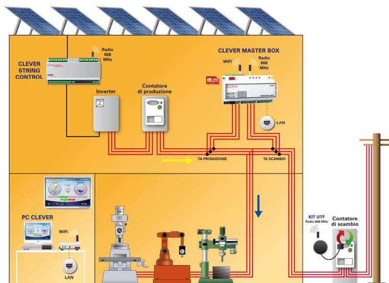
**IMPORTANTE:** Si raccomanda di prevedere un sezionatore con fusibile da 2A a monte del CLEVER per protezione e per poter togliere alimentazione all'apparato.
